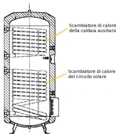
Figura 1.5: Sezione assiale di un serbatoio solare termico
